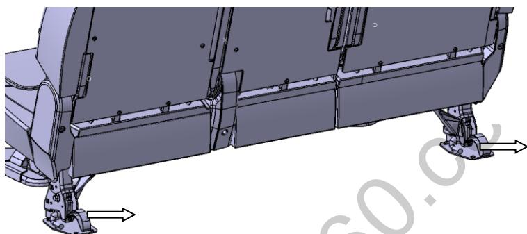
3. 拆除座椅支架上后端两颗螺栓，之后将座椅向后旋转，使自然防御地板上
