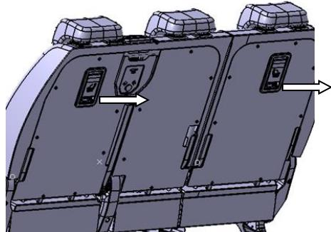
2. 在拉起坐垫解锁织带（两处同时拉起），同时将座椅翻装并锁止（锁止见使用手册）；
